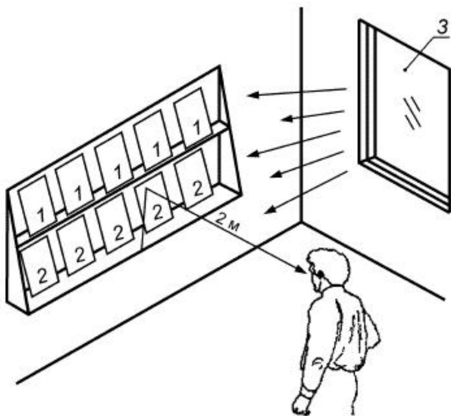
1 - эталонные образцы; 2 - контролируемые образцы; 3 - источник освещения (окно)
